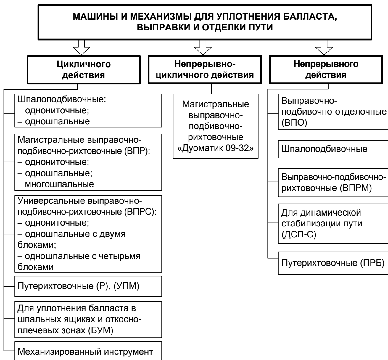
Рис. 11. Классификация машин для уплотнения балластной призмы, выправки и отделки пути
