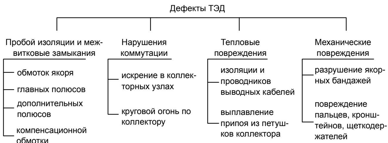
Рис. 7.1. Распространенные дефекты ТЭД
