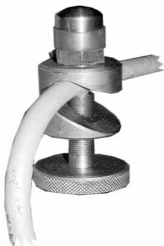
Рис. 4.1. Установка виброакселерометра на ТВД
