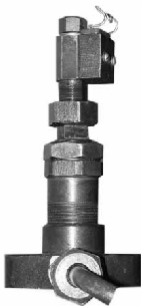
Рис. 4.2. Установка индуктивного датчика на форсунке
