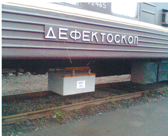
Рис. 3. Размещение георадара на АДМ-500 при обследовании участков Минераловодской дистанции пути и на вагоне-дефектоскопе при обследовании перегона Батайск-Азов Северо-Кавказской железной дороги
