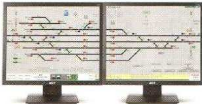
АРМ дежурного по станции на базе персональных компьютеров промышленного исполнения
