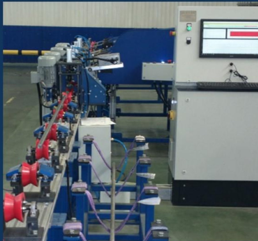
Фото: информационно-управляющий комплекс со сканирующим устройством и оборудованием механизации
