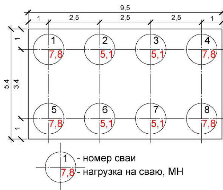
Рисунок Е.10 – Схема расположения свай в кусте с нагрузкой
