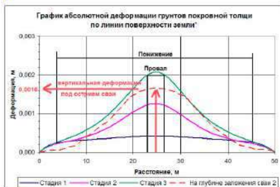
Рисунок А.6 – Пример анализа графиков абсолютных деформаций, построенных по линии земной поверхности и на глубине заложения фундамента, с целью определения прогнозных морфометрических параметров: А – провалов и локальных оседаний; Б – провалов и понижений; В – провалов, понижений, а также полостей в основании фундамента (под острием сваи)
