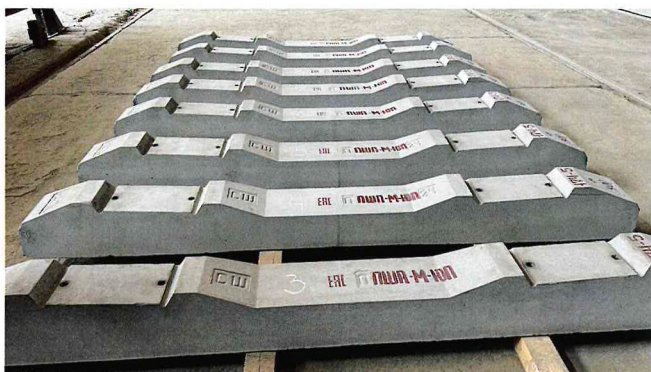
Рис. 1. Образцы шпал для горно-перевальных участков
