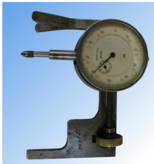
Рис. 6.22. Приспособление для замера глубины ползуна
