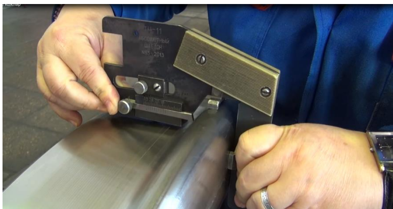
Рис. 6.18. Абсолютный шаблон вертикального подреза гребня
