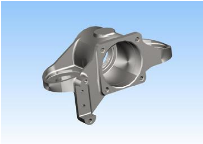
Рис. 6.28. Корпус буксы, используемый при шпинтонном буксовом подвешивании
