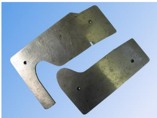
Рис. 6.15. Максимальный шаблон для проверки профиля катания гребня и контршаблон для максимального шаблона
