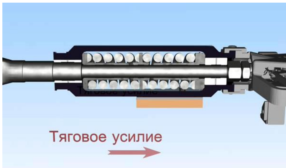
Рис. 9.15. Работа ударно-тягового аппарата. Тяговое усилие
