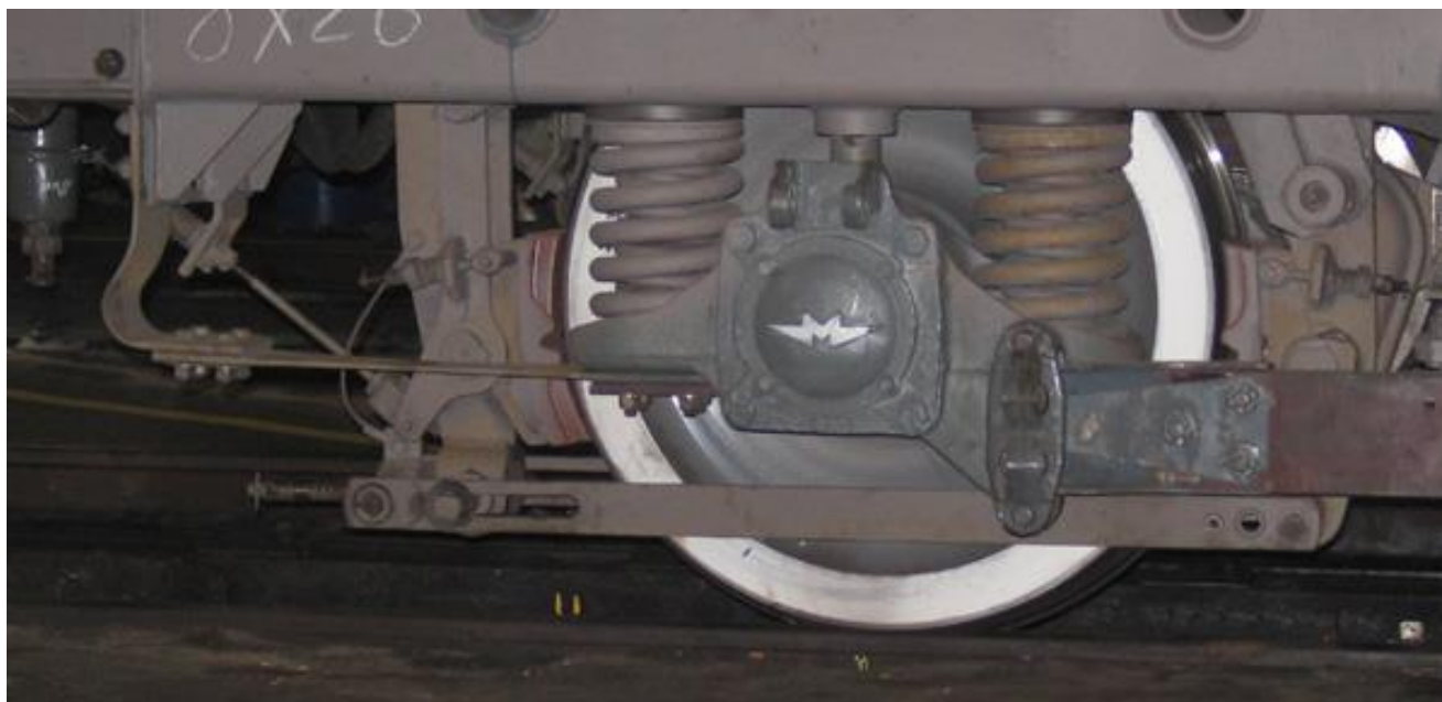
Рис. 6.3. Поводковое буксовое подвешивание
