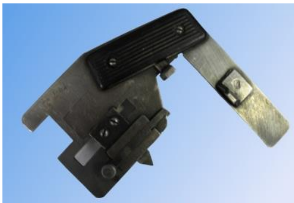
Рис. 6.18. Абсолютный шаблон вертикального подреза гребня
