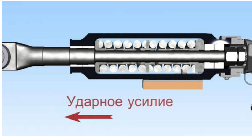
Рис. 9.16. Работа ударно-тягового аппарата Ударное усилие
