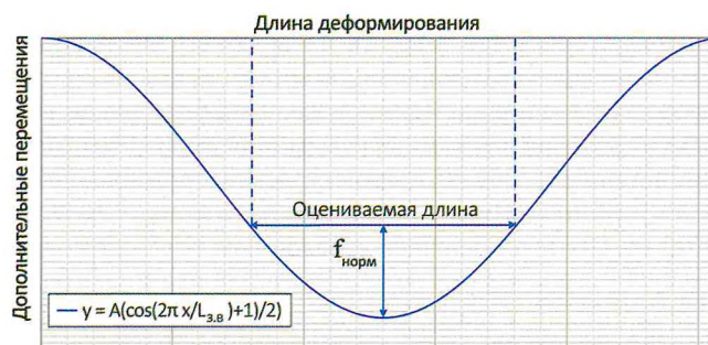
Рис. 6. Пример определения неровностей
