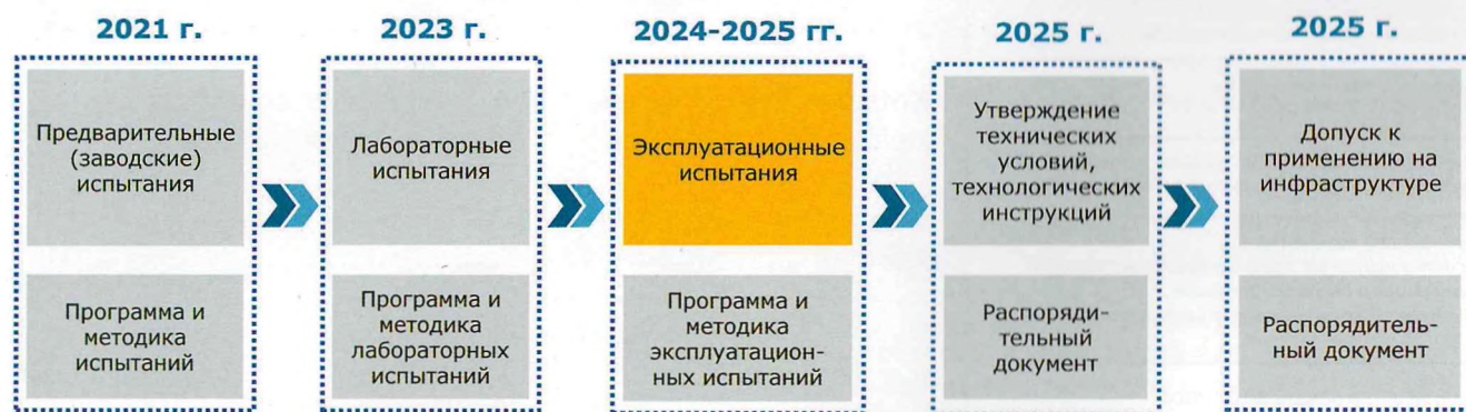
Рис. 2. Стадии испытаний для допуска на инфраструктуру технологии ремонта дефектных рельсов и крестовин стрелочных переводов лазерной наплавкой
