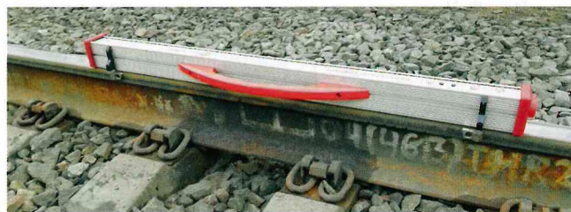
Рис. 7. Электронная линейка на головке рельса
