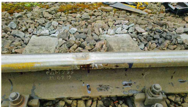
Рис. 2. Типичный дефект на поверхности катания головки рельса
