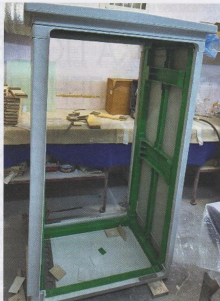
Напольный шкаф в полимерном корпусе: батарейный шкаф (слева), полимерный каркас шкафа (в центре)
