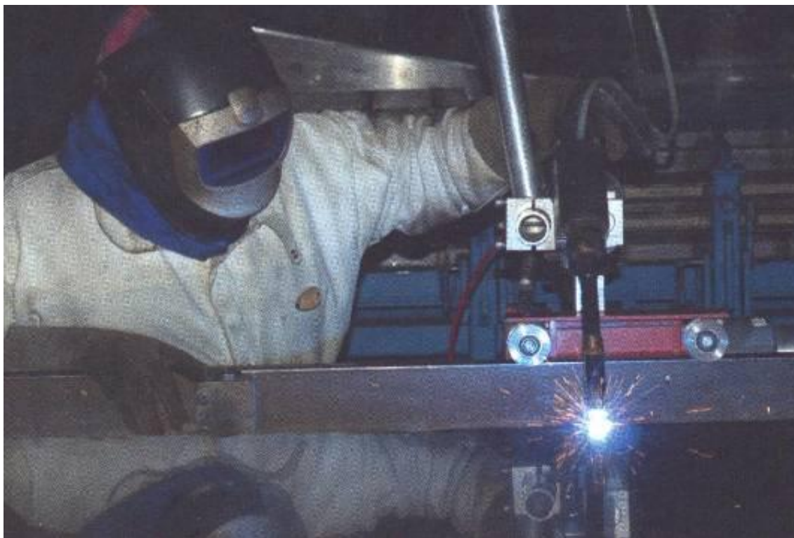
Полуавтоматическая сварка элементов кузова вагона с использованием технологии CMT
