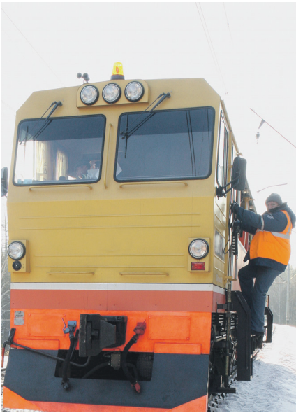
Автоматизированная система высокоточной съёмки, расчётов и выправки пути облегчит работу путейцев
