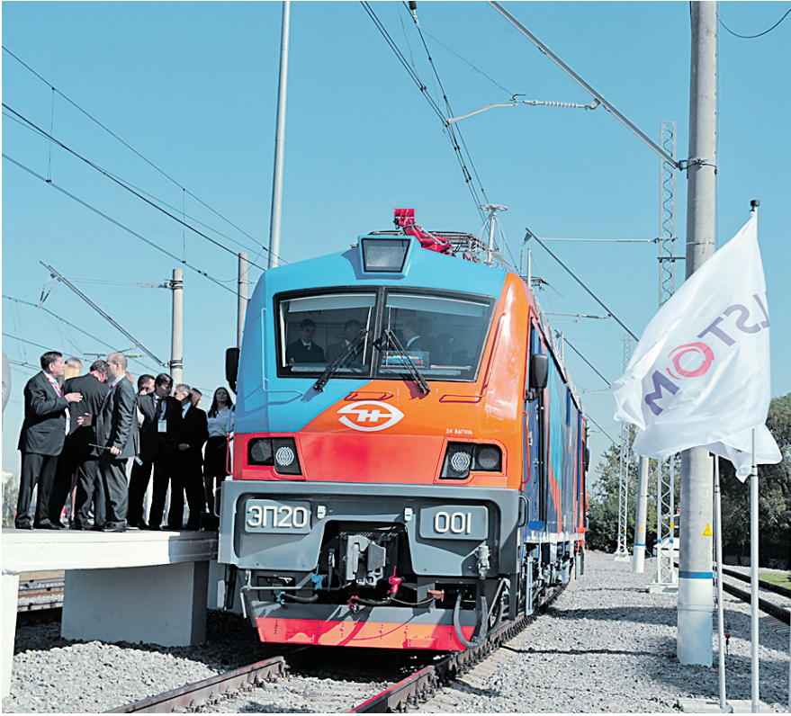
Пассажирский электровоз двойного питания ЭП20 создан в кооперации с фирмой «Альстом»
