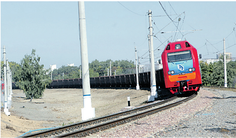
Рекордная поездка газотурбовоза ГТ-1 по Экспериментальному кольцу
