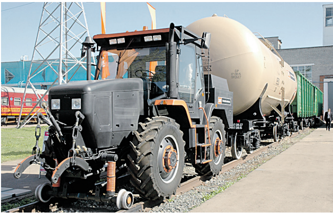
Тяговый модуль способен заменить маневровый локомотив
