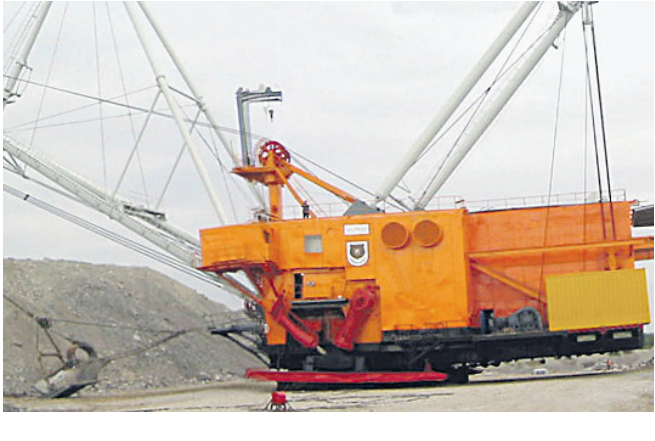
Масса шагающего экскаватора может достигать 10 тыс. тонн
