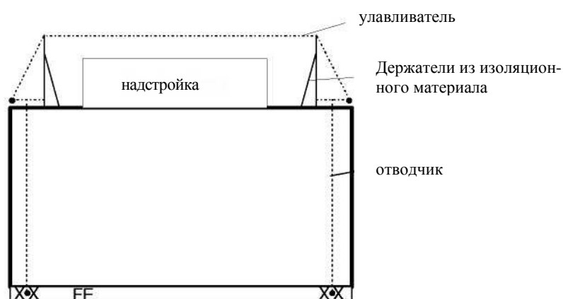
Рис. 25. Надстройки на крыше с улавливателем, устанавливаемым изолированно
