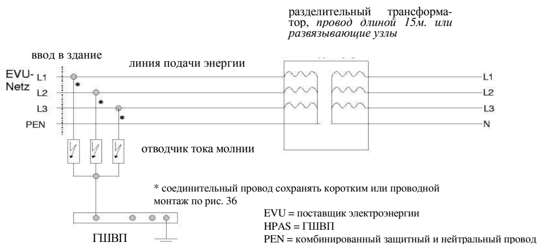
Рис. 51. Грубая грозозащита для подачи энергии от основного источника питания
