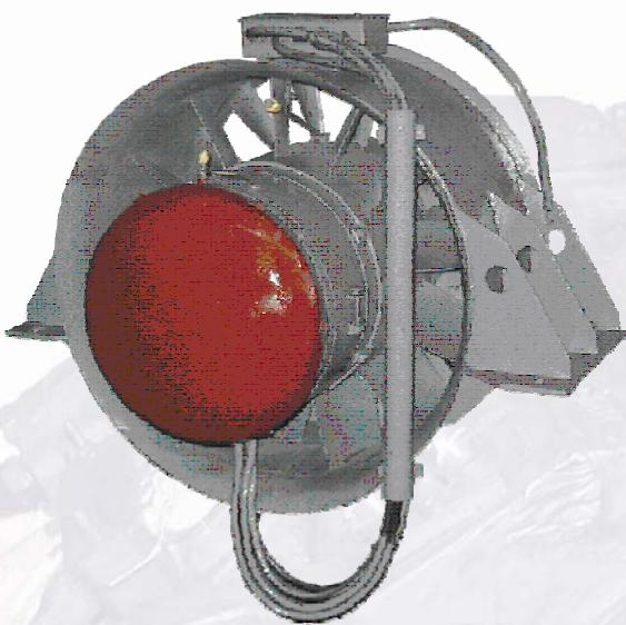
Электродвигатель предназначен для привода одноступенчатого вентилятора с диаметром рабочего колеса 800 мм, охлаждающего пуско-тормозные резисторы. 4-х полюсный с добавочными полюсами и волновой обмоткой ротора двигатель имеет односторонне выведенный вал, на который насанено рабочее колесо вентилятора.
