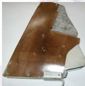
Камеры дугогасительные предназначены для гашения электрической дуги при срабатывании аппарата и предотвращают перебрасывание её на другие близкорасположенные аппараты и металлоконструкции. Камеры дугогасительные устанавливаются на аппараты, имеющие систему дугогашения типа ПК, МК, БК и др.
