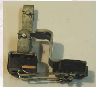
Низковольтные блокировки устанавливаются на высоковольтных аппаратах для осуществления необходимой последовательности в действиях аппаратов и предотвращения попадания обслуживающего персонала под высокое напряжение. Устанавливаются на все виды подвижного состава.
