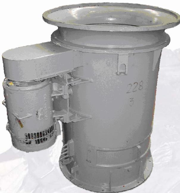
Электродвигатель служит для привода 2-х ступенчатого вентилятора. Имеет 2-х сторонний вывод вала, на концах которого насыжены колеса с лопатами 2-х ступенчатого аксиального вентилятора.
