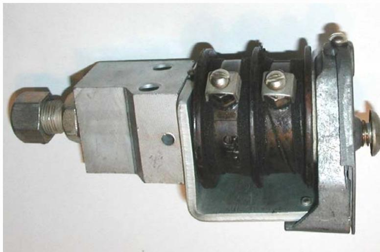
Вентили электромагнитные являются составной частью пневматических приводов для дистанционного управления приводами, приводимыми в действие сжатым воздухом (пневматические контакторы, клапаны, переключатели и т.д.).
