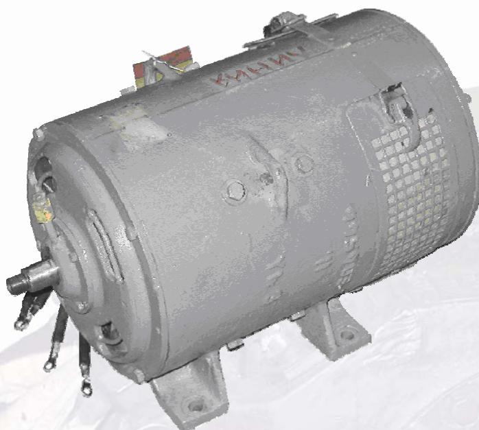
Генератор тока управления предназначен для питания цепей управления электровоза и зарядки аккумуляторных батарей. Генератор тока управления приводится во вращение с помощью клиноременной передачи, связывающей валы двигателя вентилятора и генератора. Генератор снабжён четырьмя главными полюсами, дополнительных полюсов нет
