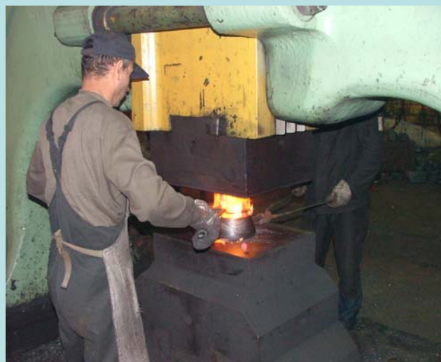
Свободная ковка на 3-х тонном молоте
