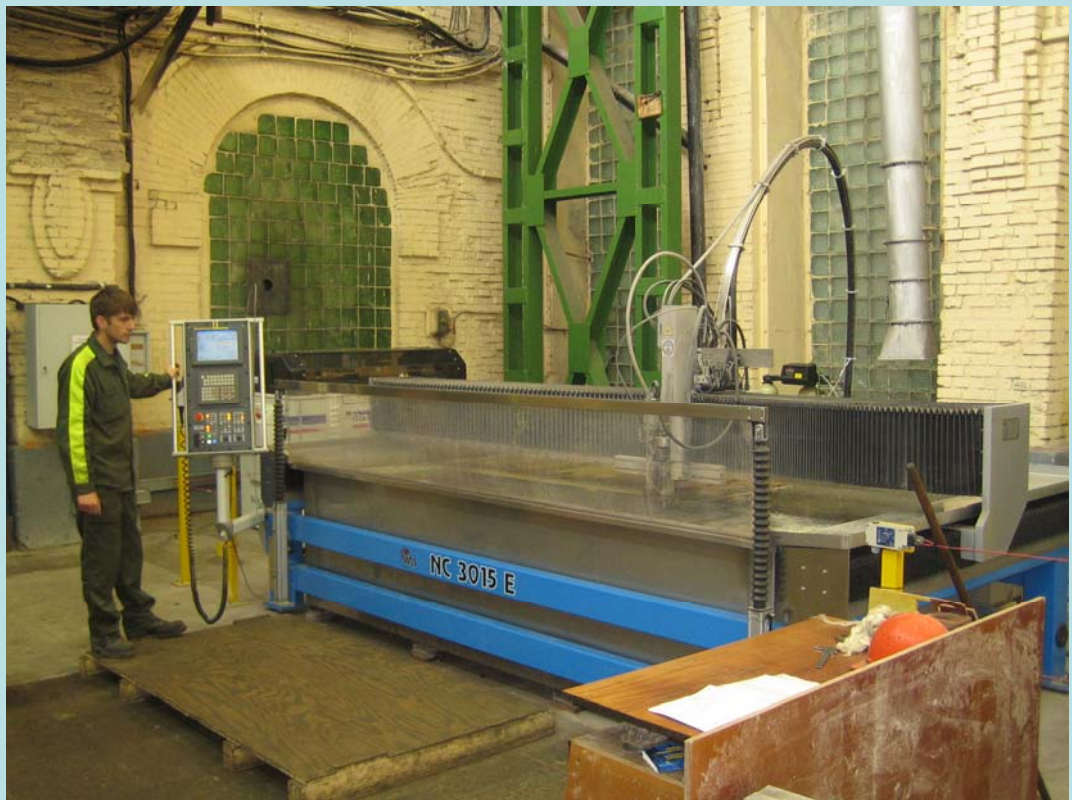
Установка гидроабразивной резки WATER JET SWEDEN AB модели NC 3015 E предназначена для раскроя металлического и неметаллического листового материала толщиной до 50 мм.
