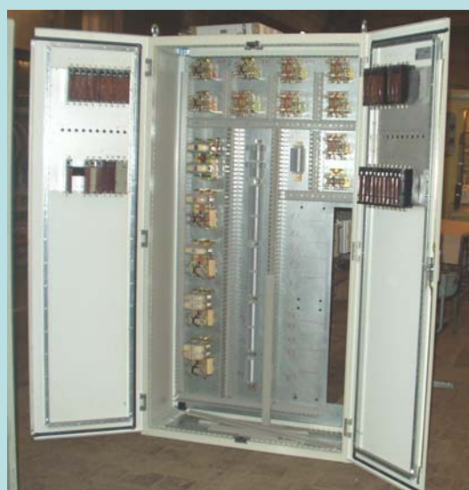
Релейный шкаф управления электровоза ЭП2К
