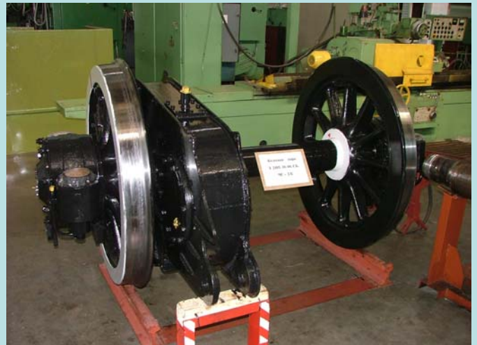
Колесная пара нового формирования ЧС2К с буксами и редуктором
