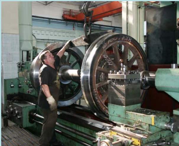
Установка колесной пары для механической обработки
