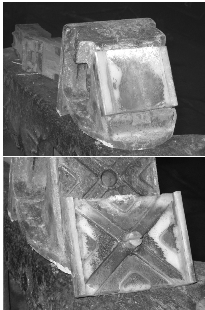
Рис. 1.10. Фрикционный клин: 1 – клин; 2 – накладка
