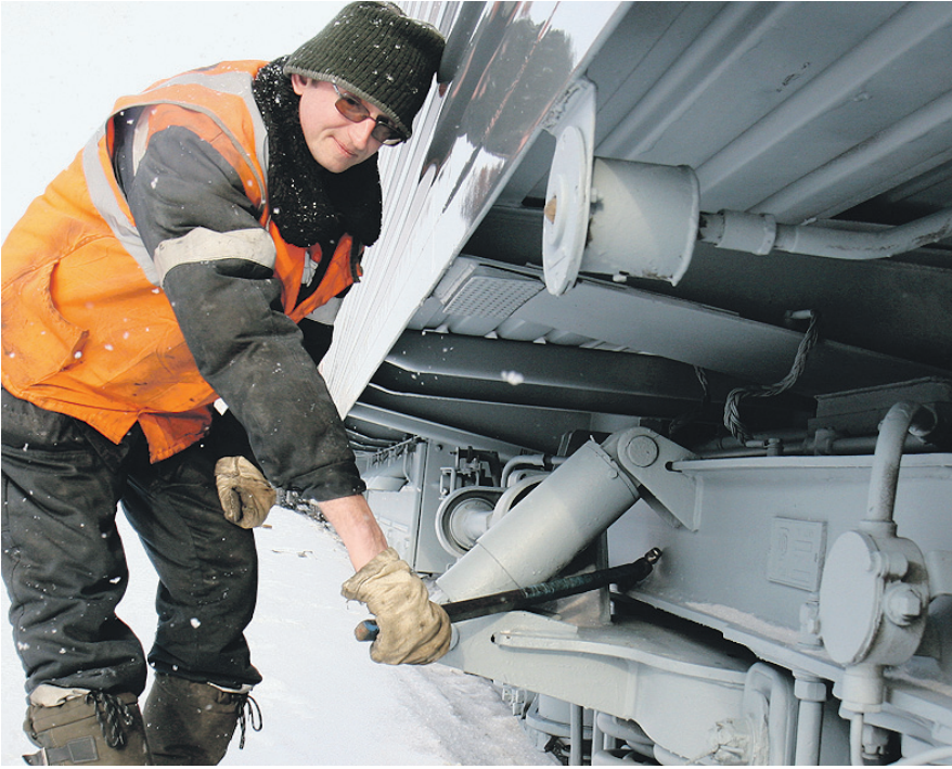
Осмотрщик вагонов Сергей Слепов проверяет гаситель колебаний на излом
