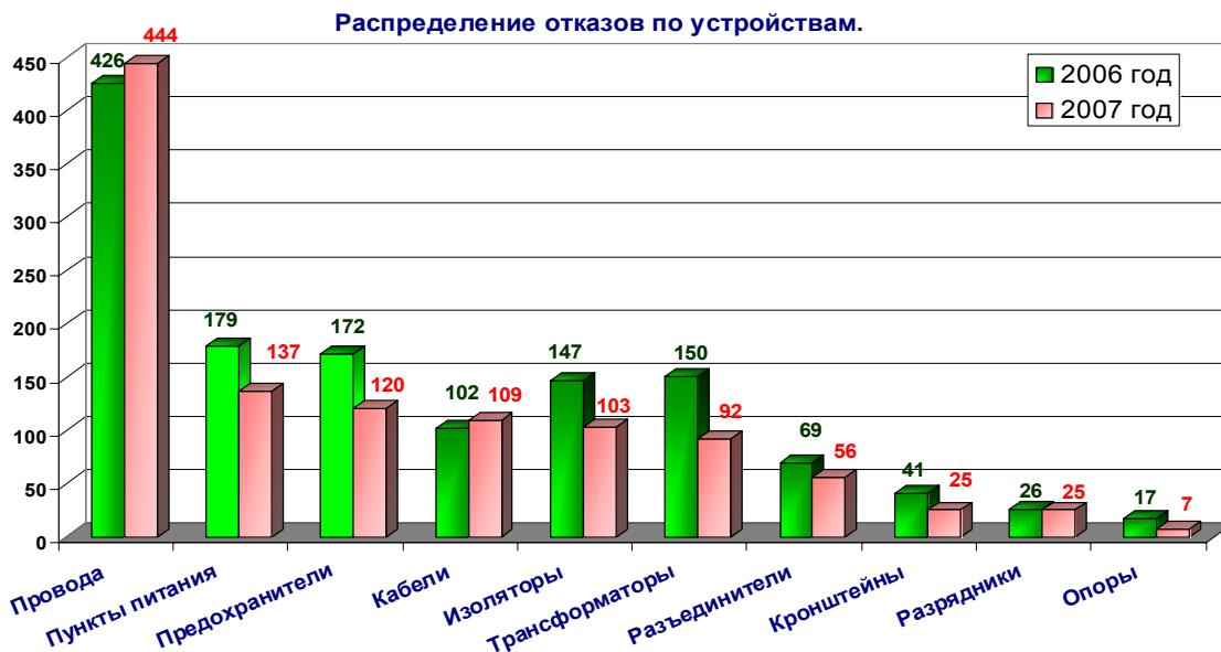
В целях повышения надежности работы устройств электроснабжения СЦБ за счет инвестиционных средств Программы обновления в 2007 году на сети дорог модернизировано 347 км линий электроснабжения СЦБ. По капитальному ремонту заменено 1,34 тыс. км проводов, 14,1 тыс. опор и 95,7 тыс. изоляторов высоковольтных воздушных линий. В целях сокращения полигона
