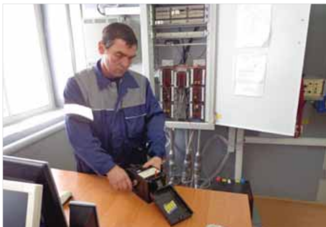
Старший электромеханик Т.Х. Гаянов измеряет сопротивление изоляции кабеля
