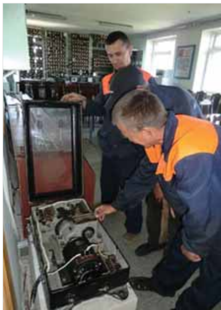
Электромеханики И.А. Валиуллин, С.Е. Ивановский и И.И. Низамов во время практических занятий проверяют внутреннее состояние электропривода
