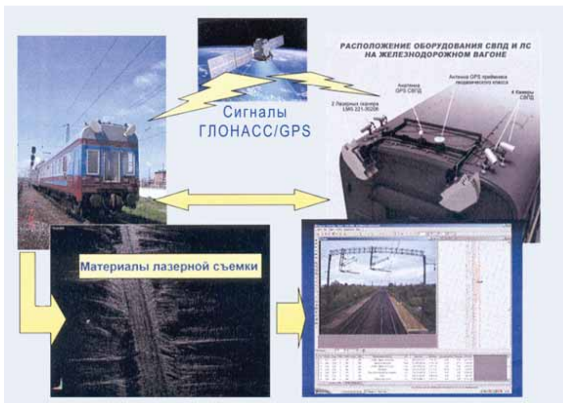
РИС. 3. Формирование цифровых карт железнодорожных путей и объектов инфраструктуры на основе комплексной обработки информации ГЛОНАСС/GPS, данных наземного лазерного сканирования и видеосъемки
