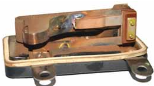
Автоматический низковольтный выключатель АВМ 1 на ток 15 А после воздействия грозового разряда
