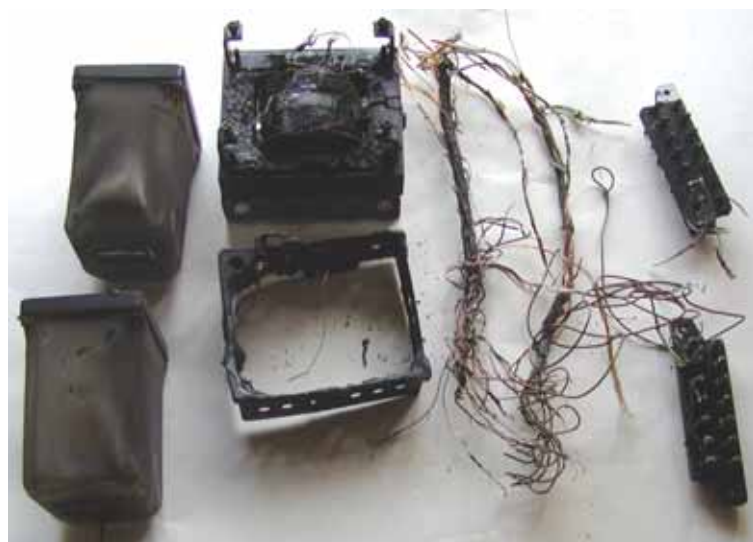
Приборы релейного шкафа после воздействия грозового разряда и возгорания
