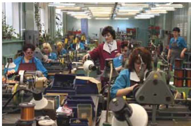
Участок намотки релейного производства
