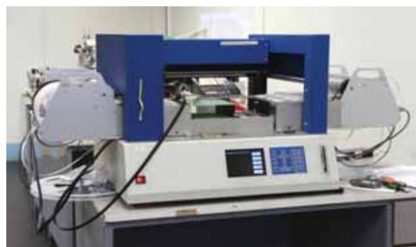
Установка для монтажа микроэлементов на поверхность печатной платы
