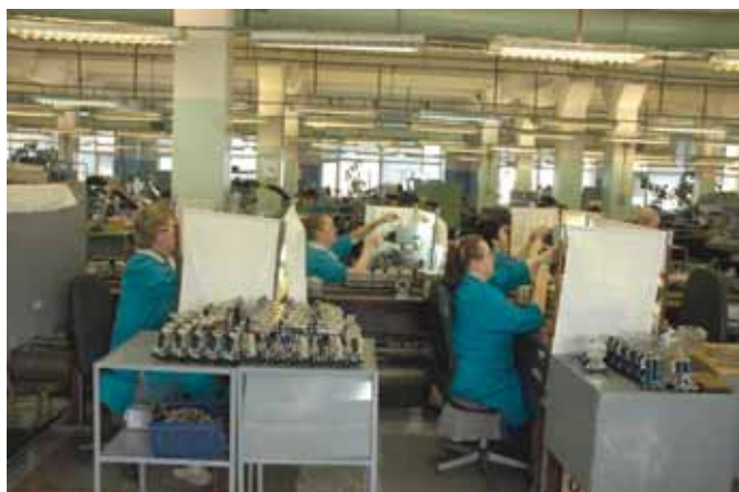
Участок регулировки реле типа РЭЛ
