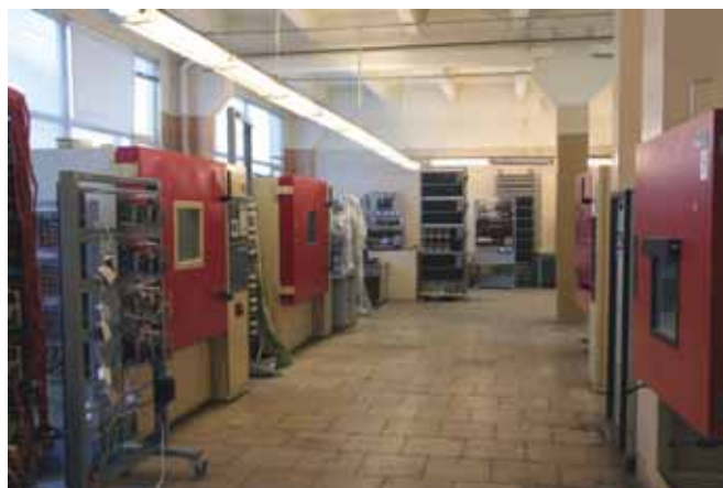
Участок термотоковой тренировки аппаратуры СЦБ
