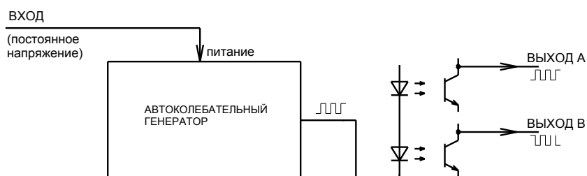
Рис 5. Функциональная схема преобразователя безопасного ввода.
