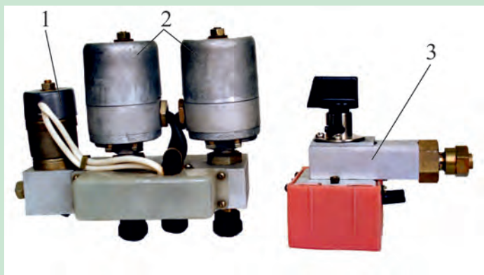
Устройство блокировки тормозов 1 – электропневматический вентиль ЭПВ 120; 2 – сигнализаторы давления 115 (СД 1, СД 2); 3 – выключатель цепей управления ВЦУ.
