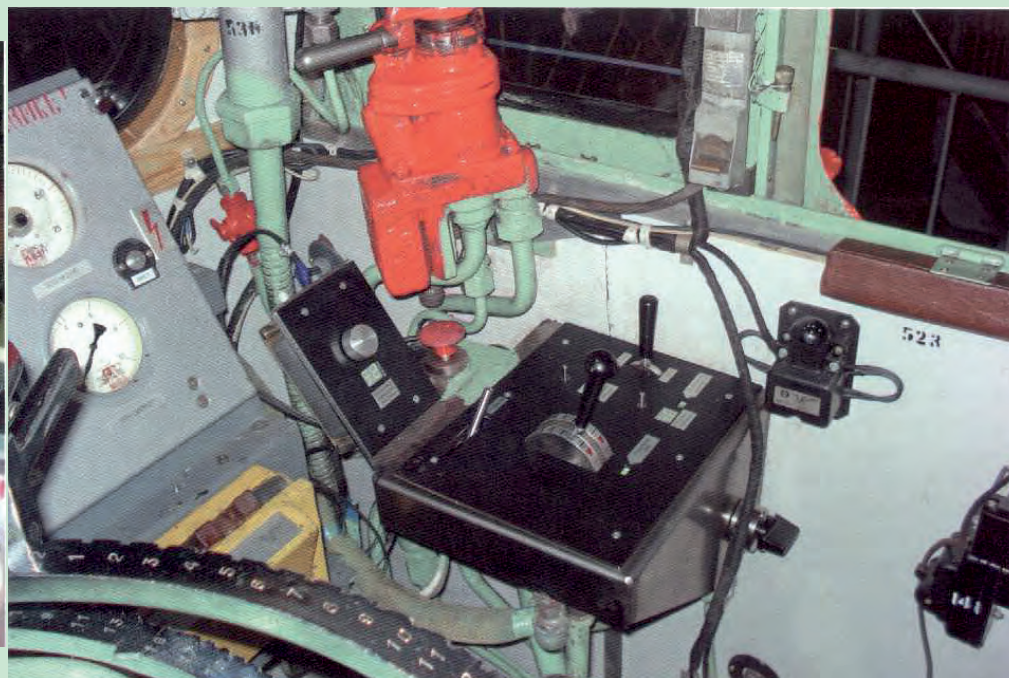
Кран машиниста 230Д на электровозе ВЛ10-269 (семипозиционный и трехпозиционный контроллеры, электронный редуктор, клапан аварий- ного экстренного торможения, выключатель цепей управления)
