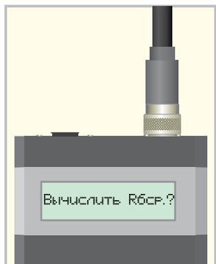
Расчет среднего удельного электрического сопротивления балласта  $R_{бср}$  производится после выполнения нескольких измерений на одной рельсовой цепи с сохранением результатов в памяти прибора.
