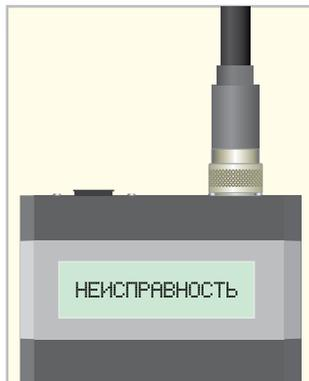
Чаще всего, сообщение «Неисправность» появляется при невозможности прибора произвести самотестирование, в следствии подключения его к измеряемому объекту в момент включения, в этом случае следует:
