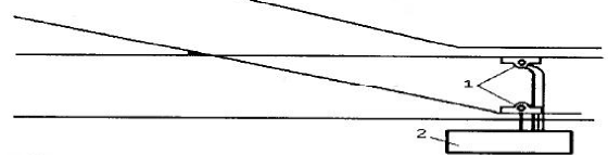
Рис. 1.1 Электропривод типа СВП (совместное крепление контрольных и рабочих тяг) : 1 - места отсоединения рабочих и контрольных тяг; 2 - электропривод
