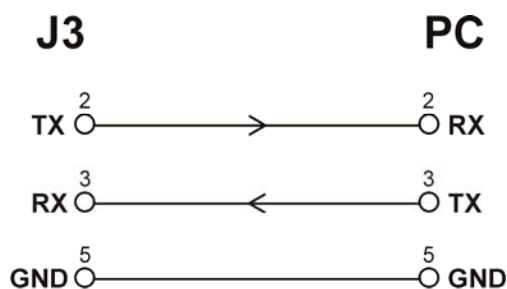
Рис. 9.1-2 Последовательный порт J27 - RS232, подключение к PC
