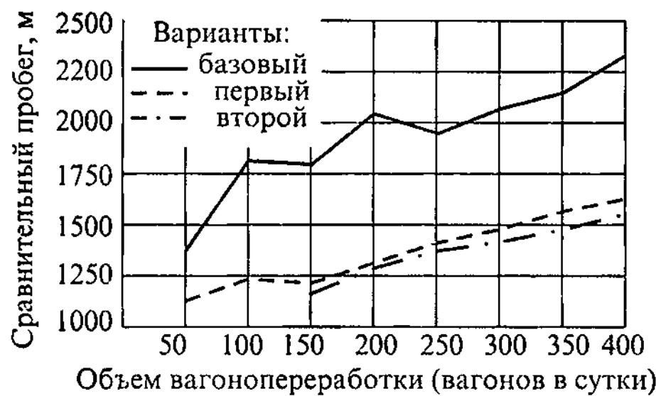
Рис. 4.7. Сравнительный пробег местного вагона по сравниваемым вариантам развития грузовых станций
