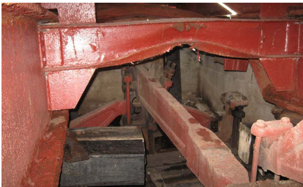
Рис. 7 - Пошкодження з'єднувальної балки внаслідок падіння платформи ваг
