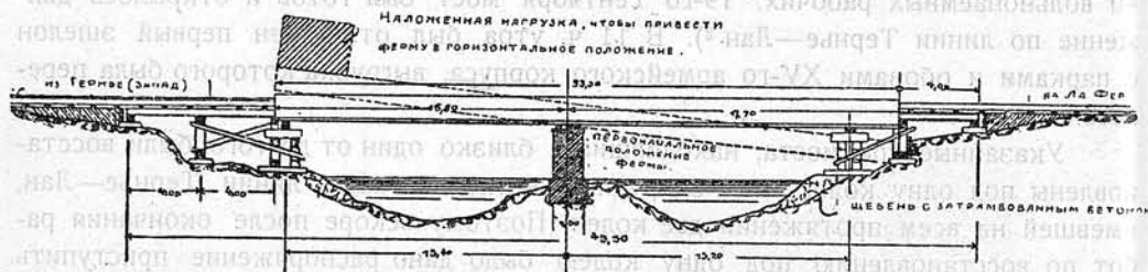
Черт. № 8. Мост через р. Уазу у Ла Фер. Восстановление 12-й ж.-д. строительной роты второй колеи, с использованием старых пролетных строений.
