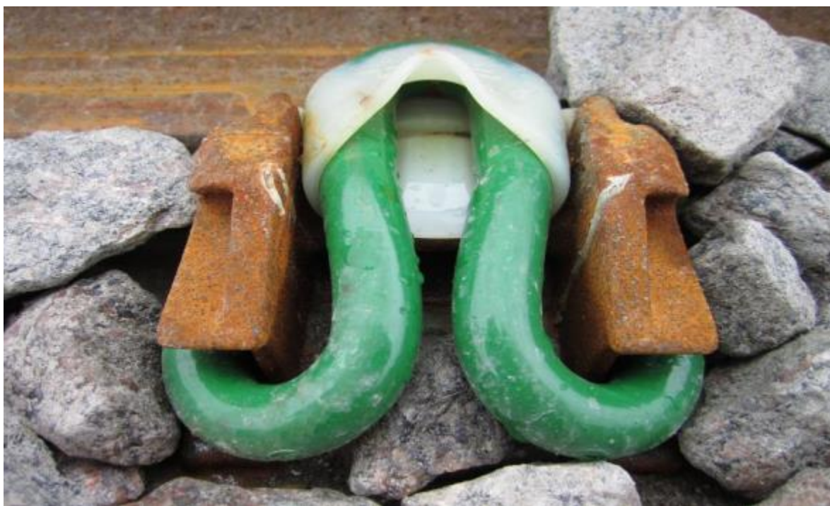
Рисунок 4. Деформация прижимного изолятора при положительных температурах.
