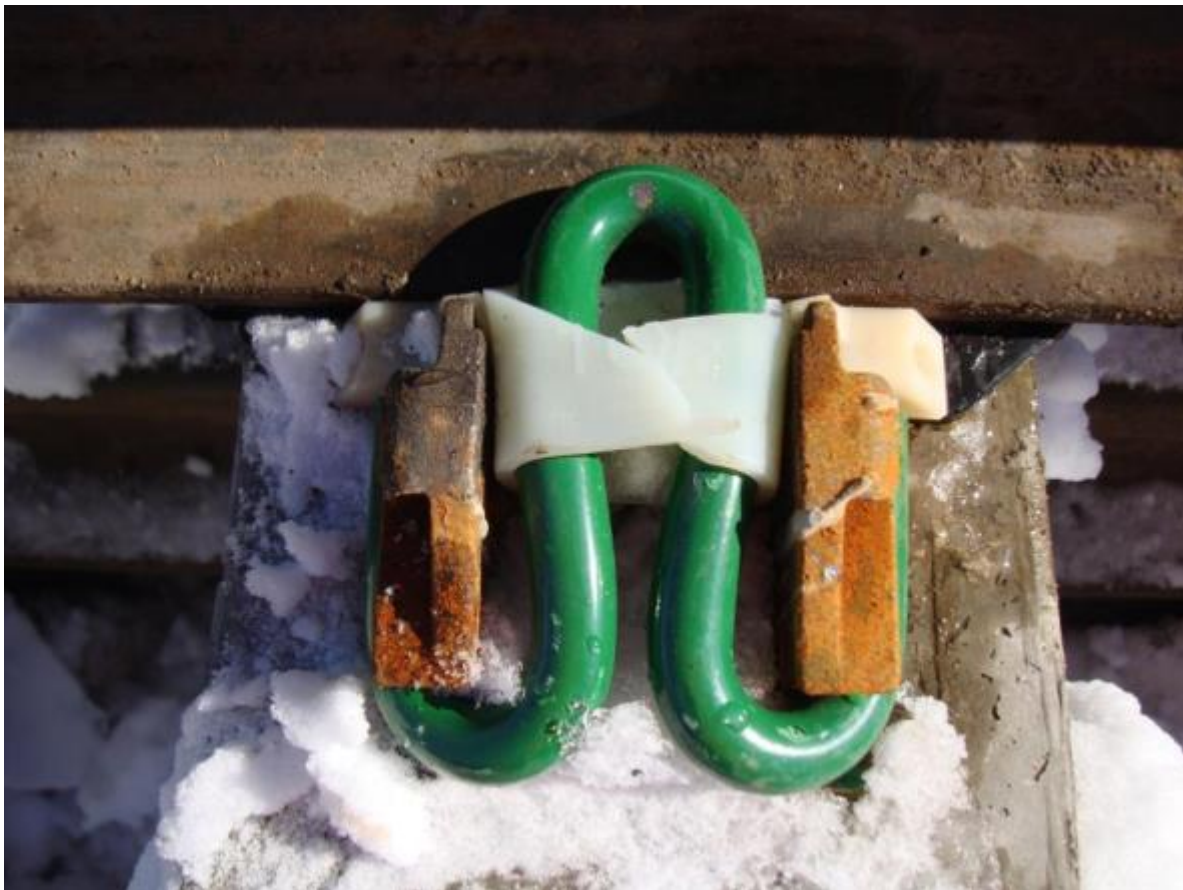
Рисунок 3. Излом прижимных изоляторов при отрицательных температурах.
