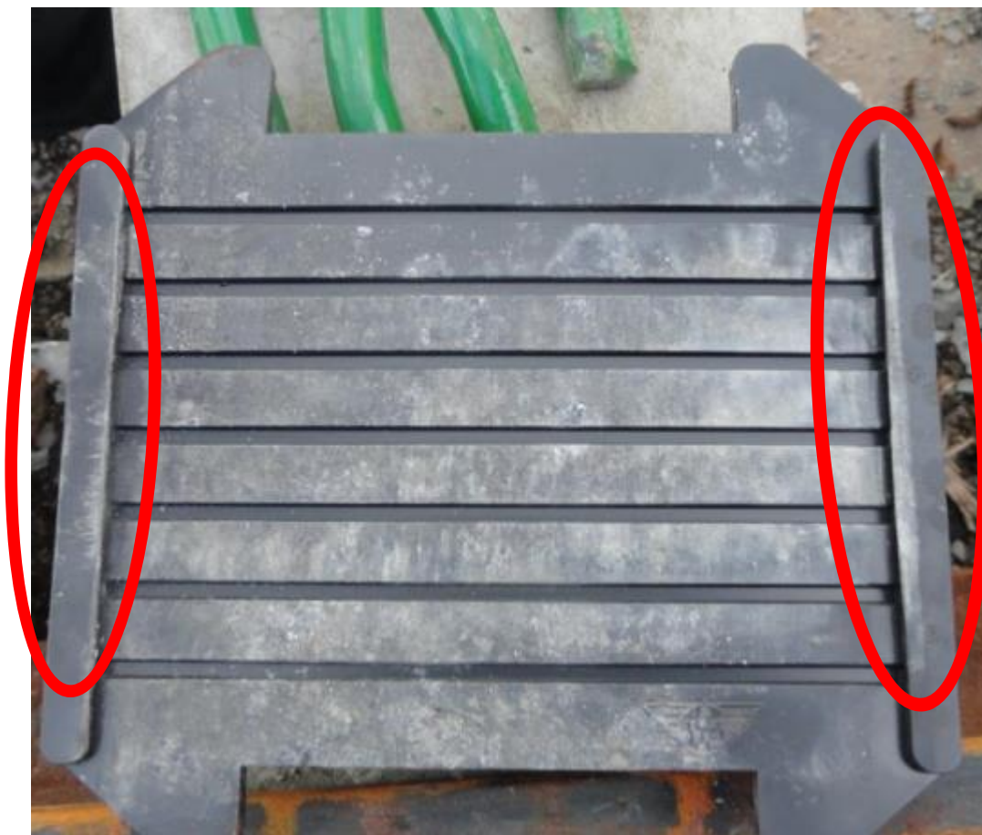
Рисунок 6. Следы от смятия прокладки.
