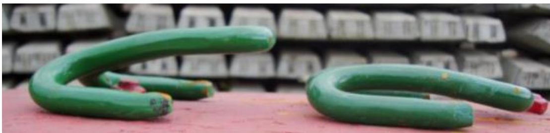
Рисунок 7. Формы клемм после воздействия путевых ремонтных машин на шпалы, после которого теряется их несущая способность.
