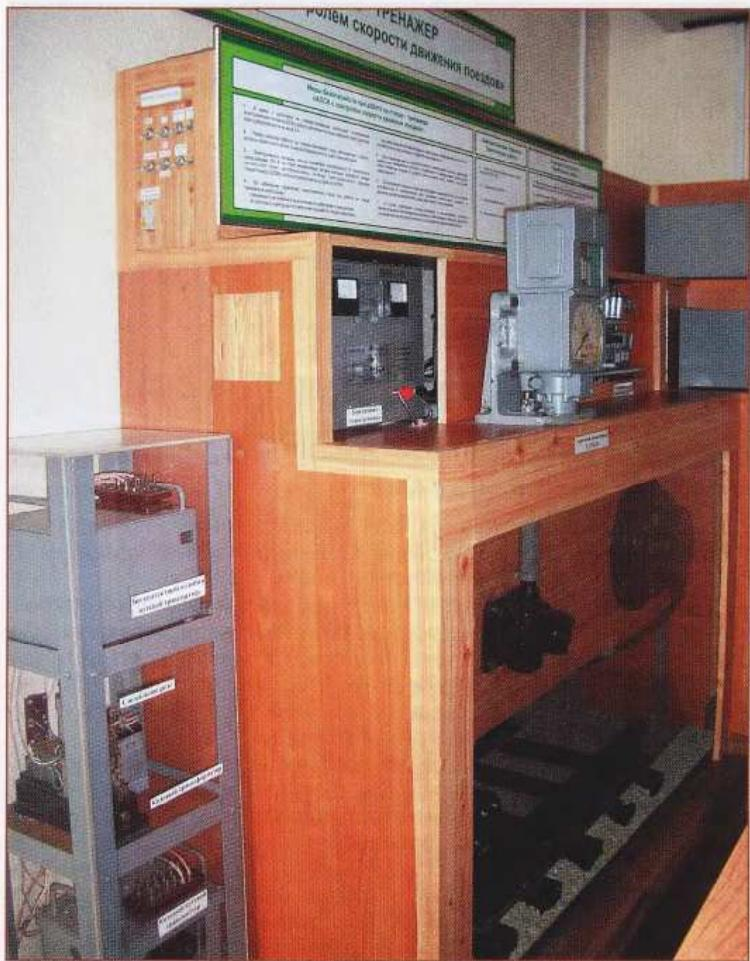
Рис. 1. Общий вид стенда-тренажера (под заголовком стенда-тренажера размещены меры безопасности при его использовании, а также практические работы: шесть по предметам «Приборы безопасности», четыре «Автотормоза», с левой стороны стенд в углу расположен релейный шкаф)
