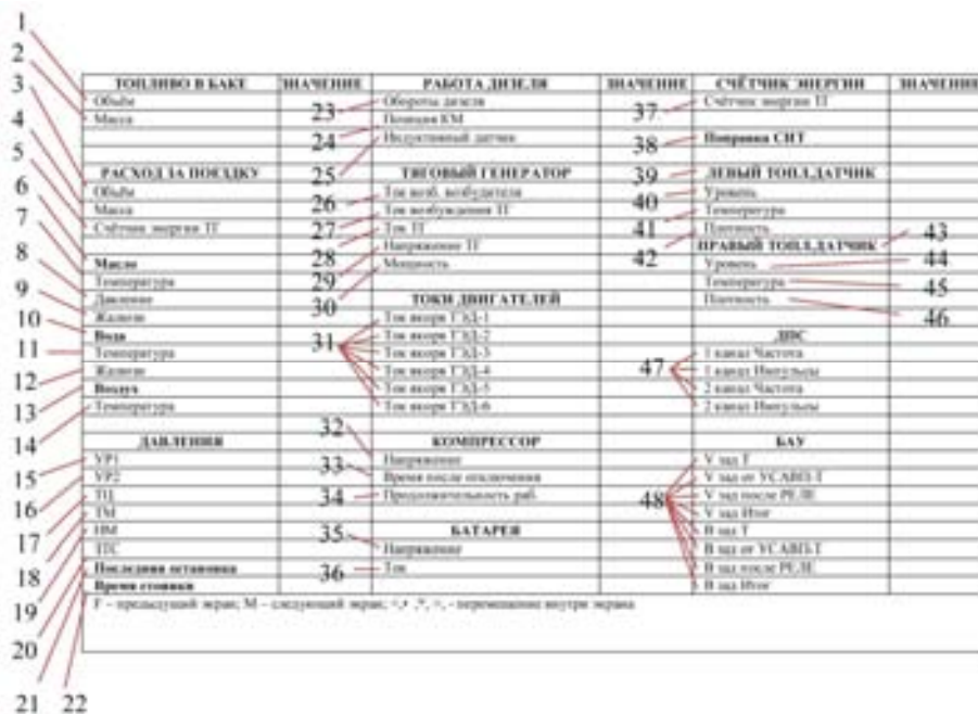
Рис. 17 Диагностический экран системы УСABП-Т (аналоговые сигналы)
