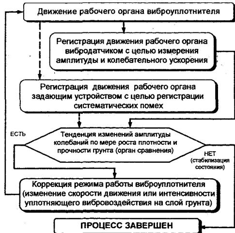
Рис. 3.4. Информационное взаимодействие элементов системы автоматического управления процессом виброуплотнения
