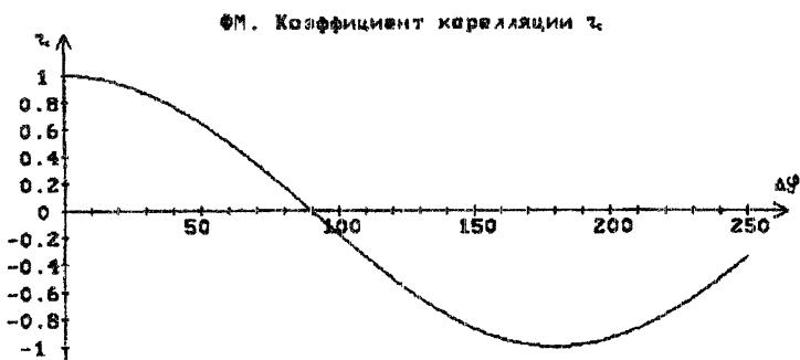
Рис. 4б. Функция взаимной корреляции при ЧМ
