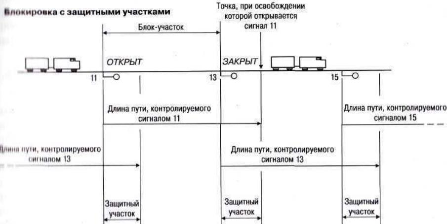
Рис. 3.12. Контролируемый сигналом путь в системах с фиксированными блок-участками
