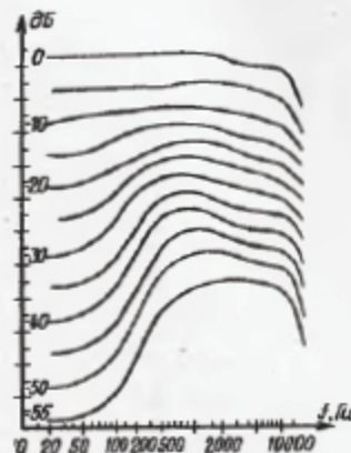
Рис. 3. Амплитудно-частотные характеристики компрессора системы Dolby C
