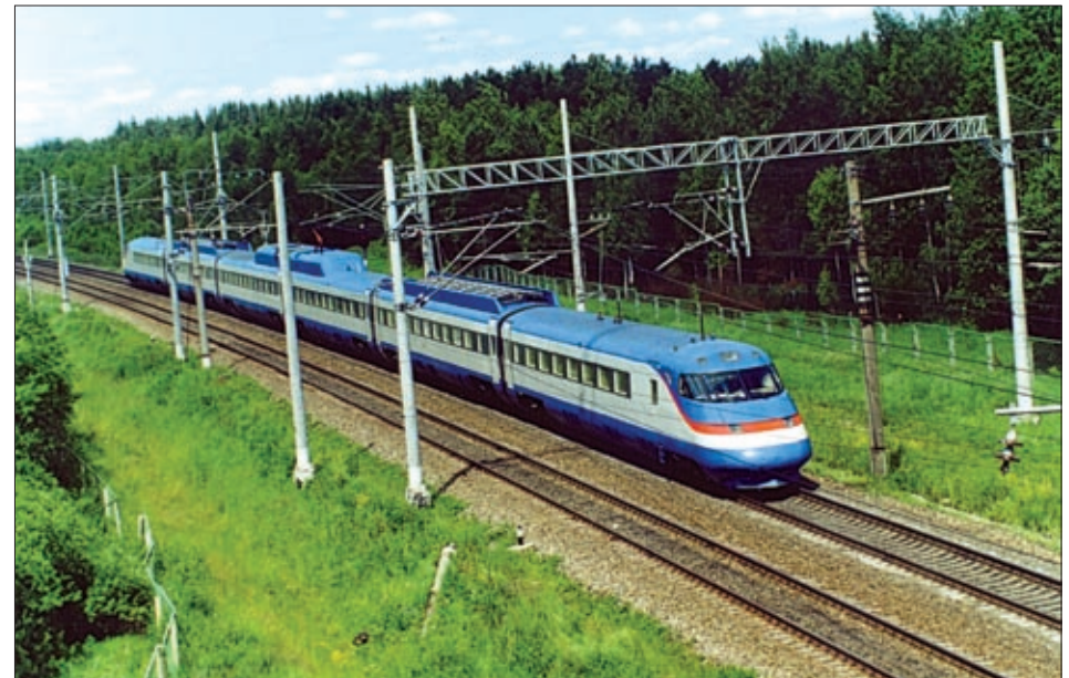
Ходовые испытания поезда «Сокол» на линии Санкт-Петербург–Москва. Достигнута скорость 236 км/час. 2001 г.
