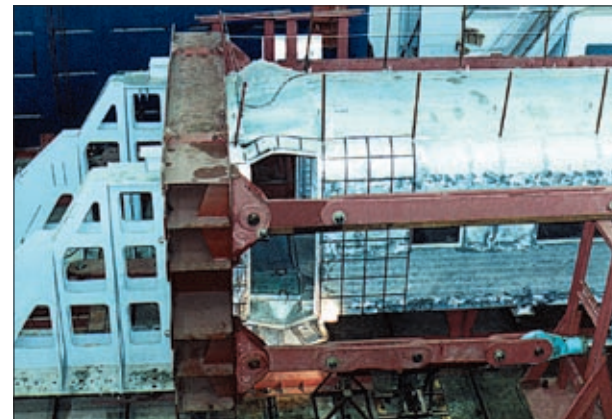
Прочностные испытания кузова вагона поезда «Сокол» в ЦНИИ им. А.Н. Крылова. 1998 г.
