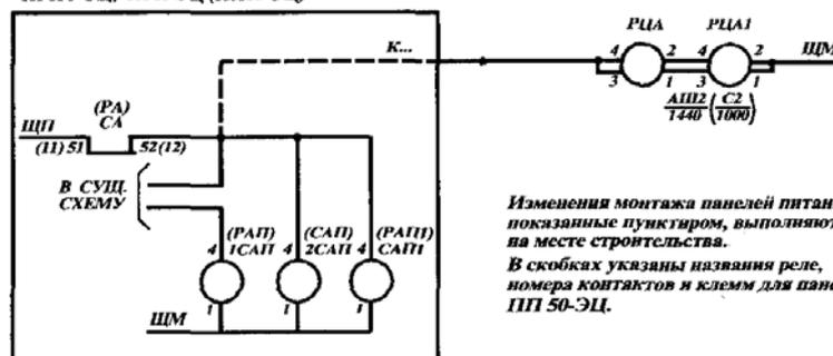
*Изменения монтажа панелей питания, показанные пунктиром, выполняются на месте строительства. В скобках указаны названия реле, номера контактов и клемм для панели ПП 50-ЭЦ.*
