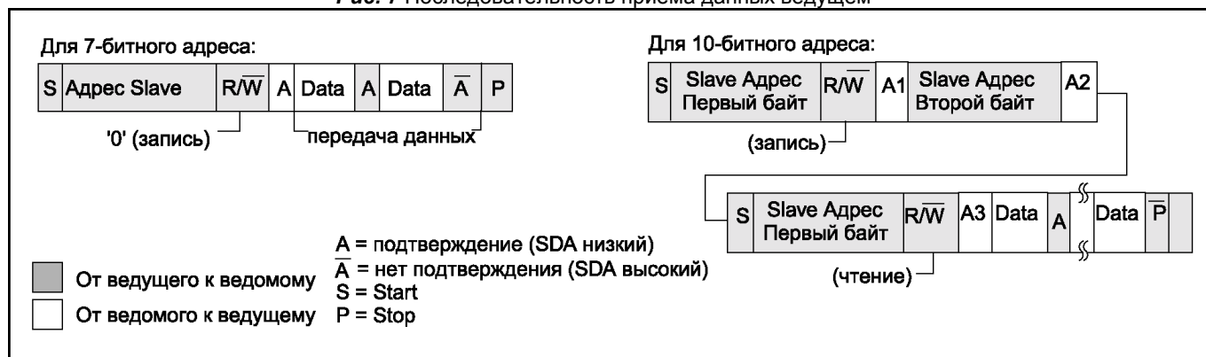
Рис. 7 Последовательность приема данных ведущим
