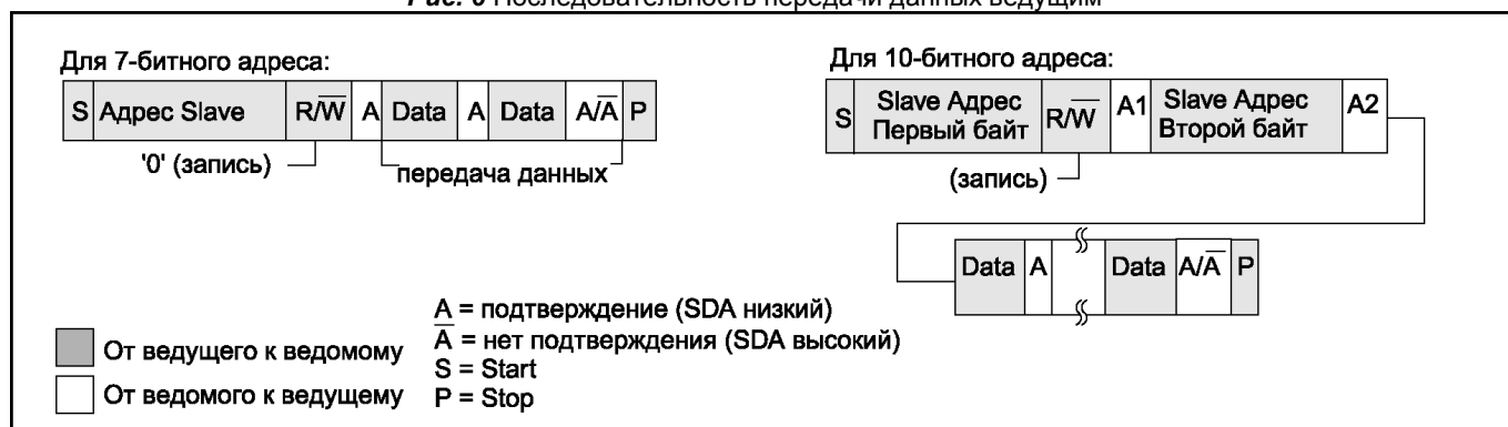
Рис. 7 Последовательность приема данных ведущим
